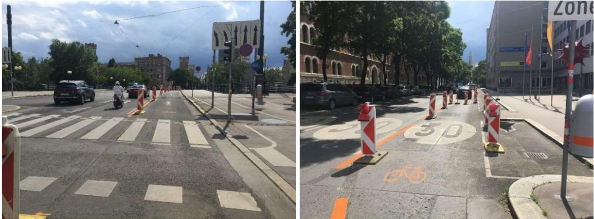
Abbildung 67: Roßauer Brücke (links): Beginn des Pop-up-Radfahrstreifens bereits auf der Roßauer Brücke in Verlängerung des Zweirichtungswegs in der Rembrandtstraße, Türkenstraße(rechts): geschützte (aber etwas versteckte) Linienführung des Pop-up-Radfahrstreifens "hinter" der Parkspur.
